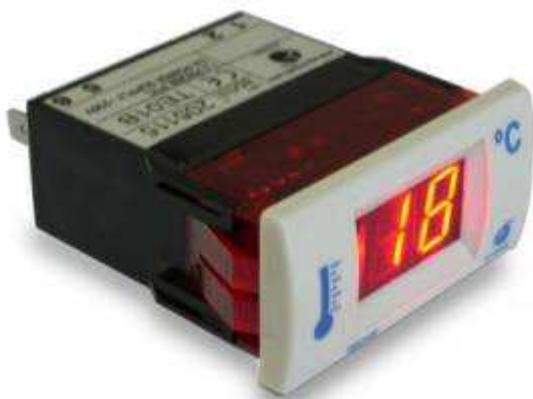
TE01B è un termometro elettronico con campo di misura da  $-50^{\circ}\text{C}$  a  $+99^{\circ}\text{C}$ . È dotato di un ingresso per sonda di temperatura di tipo PTC o NTC.
